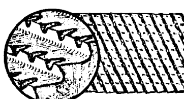
lima fresada com ranhuras para quebrar o cavaco
