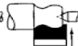
Torneamento com ferramenta de Perfilar externo
