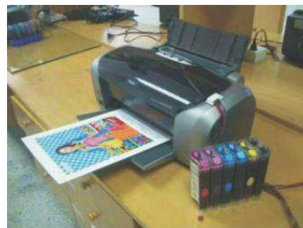
Observe nas figuras acima, que os recipientes de tinta são colocados no lado externo e as tintas são conduzidas à impressora, através de mangueiras de plástico.
