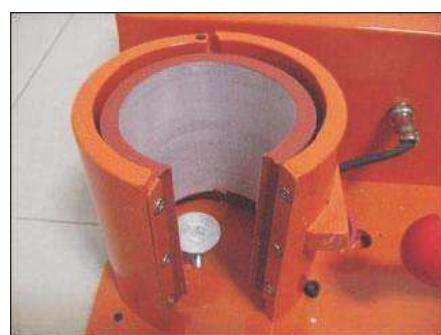
Posicione o papel transfer, com a imagem voltada para a caneca e coloque-a no bocal da máquina. Depois de colocada a caneca nesse bocal, aciona-se uma alavanca, que tem por objetivo, pressionar o papel transfer com a caneca.
