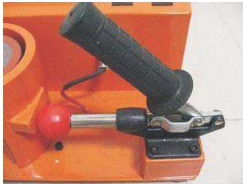
Antes porém, devemos programar a prensa para atingir a temperatura de 200°C, por 2 minutos. Transcorrido esse tempo, a máquina soa uma sirene, onde devemos voltar a alavanca, para aliviar a pressão. Em seguida, devemos retirar a caneca e esperar esfriar o papel transfer, para depois ser retirado.
