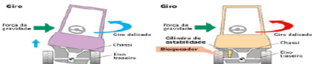
Para que haja estabilidade, qualquer equipamento precisa ter uma base de apoio. Por exemplo: Na empilhadeira, a base é feita em três pontos: dois deles estão na parte frontal da máquina, são as rodas de tração.
