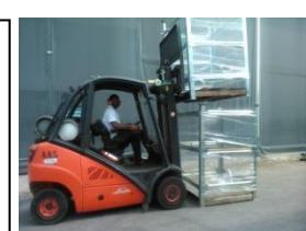
Incline a torre da empilhadeira para trás, isso aumenta a estabilidade da carga.
