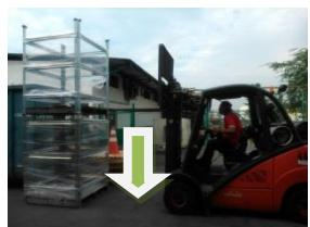
Observe bem as pontas dos garfos, retire os garfos totalmente do pallet, desça os garfos, observe e siga.
