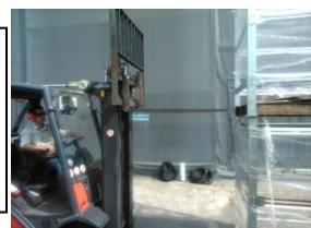
Com os freios acionados, suba os garfos o suficiente para entrar com os garfos no pallet. Posicione a torre em 90º.
