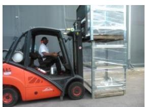
Com os garfos inseridos por inteiro no pallet, levante a carga cuidadosamente. Use os freios. Observe se existem obstáculos aéreos.
