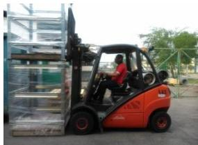
Repose a carga devagar, ao sair observe bem o posicionamento da torre (90º), não arraste os garfos.
