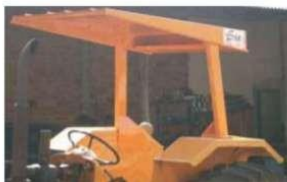
Figura 9 – Acima na esquerda, trator sem estrutura de proteção na capotagem e na direita EPC do tipo arco. Abaixo na esquerda cabine com EPC de quatro pontos e à direita anteparo para proteção contra o sol, sem qualquer efeito como EPC.
