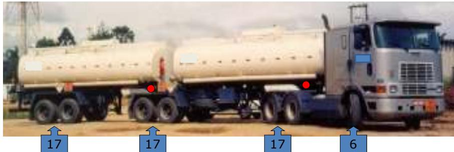
Conjunto do Tipo Bitrem - 3 veículos, 7 eixos, 2 articulações (engate do tipo "B" – por isso chama-se "B-Train" ou trem do tipo "B", aportuguesado para Bitrem) e PBTC de 57 ton. Capacidade de Carga ~ 38 ton.
