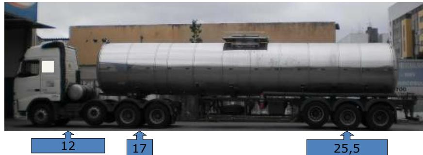
Conjunto do Caminhão-trator 8X2 + semi-reboque c/ 3 eixos juntos - PBTC de 54,5 ton. Capacidade ~ 36 ton.
