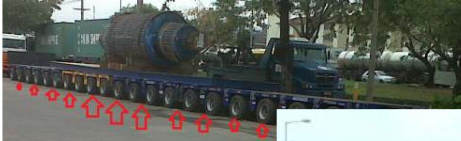
Cuidado com a distribuição de Peso entre os eixos e com a "Capacidade de Carga" dos Pneus (**Índice de Carga**)
