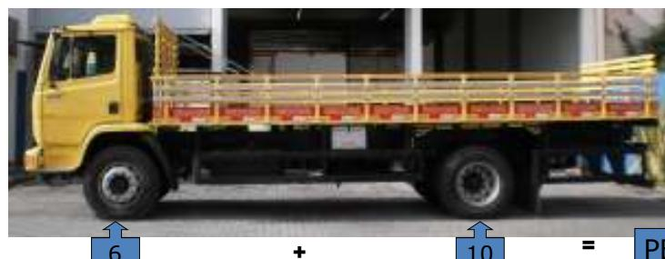
Caminhão do tipo 4x2: PBT = 16 ton. Capacidade de carga: +ou- 9,5 ton.
