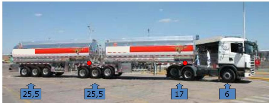
Conjunto do Tipo Bitrem 3 eixos ou “Bitrenzão” - 3 veículos, 9 eixos, 2 articulações e PBTC de 74 ton. Capacidade ~ 52 ton.
