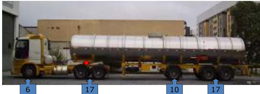
Conjunto do Caminhão-trator + semi-reboque c/ 1 eixo distanciado (2+1) -
