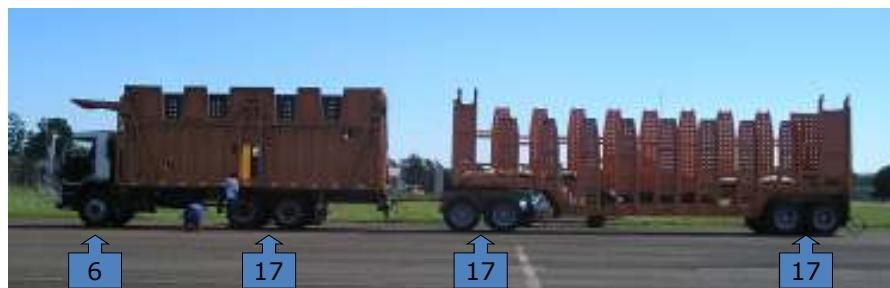
Conjunto do Caminhão-Carroceria + Reboque 4 eixos - PBTC de 57 ton.
