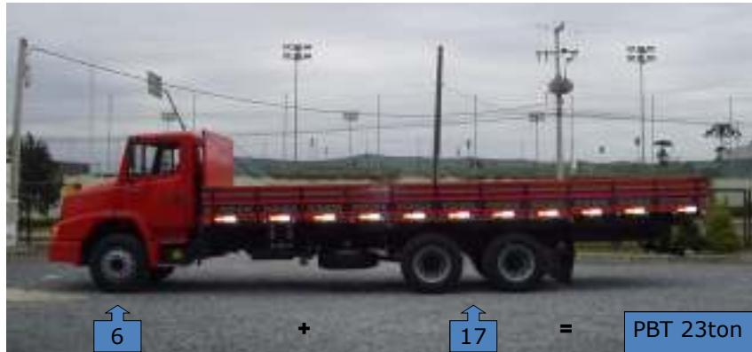
Caminhão do tipo 6x2 ou 6x4. PBT: 23 ton. Capacidade de carga ~ 15 ton
