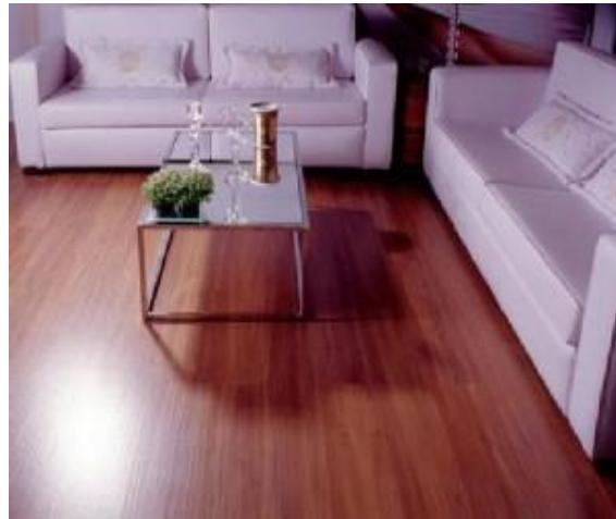
O carpete de madeira é um piso flutuante industrializado de madeira com réguas prontas . A estrutura é feita de madeira compensada, sobre a qual é fixada uma lâmina decorativa fina, com 0,6 milímetros de espessura. Que é uma película de madeira natural com 5 a 10 camadas de verniz. As réguas do piso são coladas umas nas outras sem serem travadas no chão.
