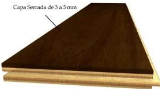
É possível restaurá-lo o piso estruturado, pois ele aceita ser lixado de 3 a 4 vezes. A instalação é feita por cola aplicada nos encaixes macho-fêmea das réguas do piso. Esse tipo de piso flutuante de madeira tem a mesma resistência a riscos do piso de madeira tradicional (assoalho). Porém os assoalhos duram mais, porque podem ser restaurados mais vezes.
