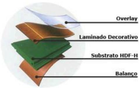
O piso laminado é um piso flutuante de madeira de encaixe, com visual fiel à madeira, compostos por 4 camadas: O substrato (miolo) é feito de HDF, que são Tábuas de Fibra de Alta Densidade; O filme decorativo é uma camada que recebe a impressão fotográfica dos veios, texturas e cores da madeira.
