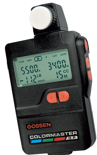
Figura 1.16 Medidores de temperatura de cor medem a luz por meio do disco difusor em sua parte superior. O medidor é programado para o tipo de filme (luz do dia ou tungstênio, por exemplo) e gera em sua tela uma referência para o filtro de compensação de luz necessário na objetiva da câmera ou na fonte de luz. Imagem cortesia de Gossen Foto-und-Lichtmesstechnik GmbH.
