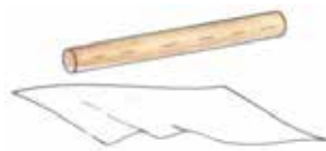
Um bastão de borracha atritado com seda adquire carga negativa.
