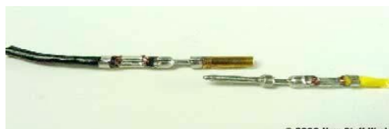
Um soquete (à esquerda) e um pino (à direita)
