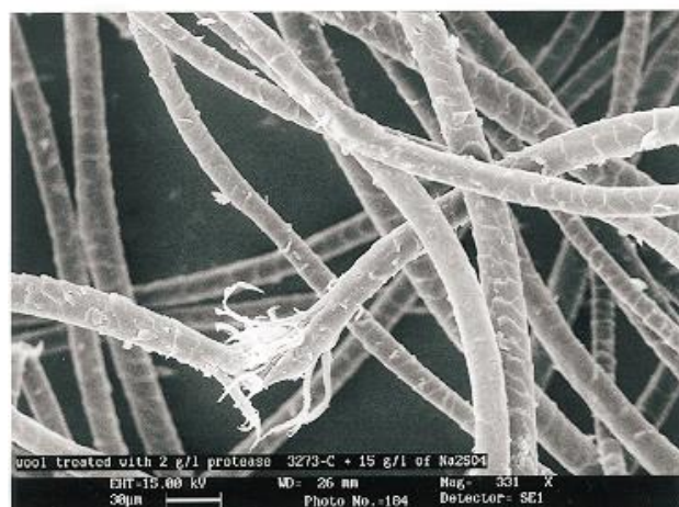
Figura 7. Amostra tratada com 2 g/L de 3273-C + 15 g/L de sal
