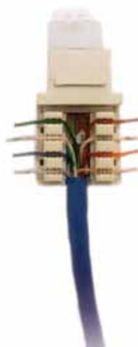
Figura 45 - Acomodação dos condutores
