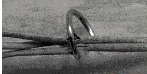
Figura 12 - Capa externa rompida (incorreto)
