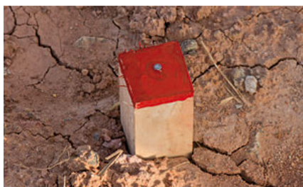
Exemplo de piquete utilizado em campo para materializar o ponto topográfico. Pode-se utilizar outros materiais
