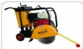
4. Cortadora de Piso (dilatação em piso industrial)
