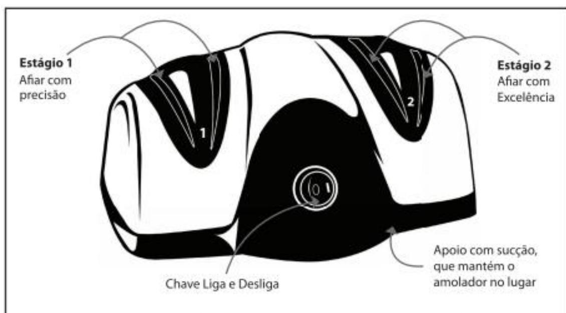
Para melhores resultados, o AMOLADOR DE FACAS ELÉTRICO LOUD é equipado com ventosas na base. Umedeça a superfície e pressione-o para melhor fixação. Ligue a unidade pressionando a chave Liga/Desliga.
