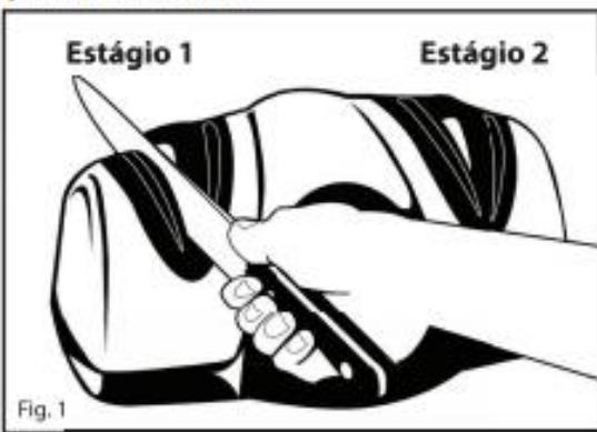
Para afiar a ponta da lâmina, levante suavemente o cabo da faca para que a parte curva da lâmina deslize por entre as lâminas guia. Ao deslizar a faca pelas lâminas guia, permaneça aproximadamente um segundo para cada duas polegadas de lâmina. Por exemplo: ao afiar uma faca com uma lâmina de 6 polegadas, você deve demorar aproximadamente três segundos em cada passada.
