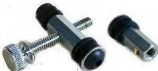
As máquinas de tatuagem têm dois pontos de conexão obrigatórios; ambos agem como pontos de conexão para os componentes elétricos da máquina. O ponto de conexão superior fica preso ao chassi e ativa o ponto de contato da máquina. O ponto de conexão traseira é o conector positivo para o clipcord.
