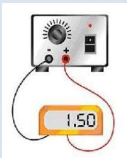
Gire o botão deslizante da fonte de alimentação e verifique se a voltagem mostrada pelo multímetro é igual à voltagem mostrada na escala da fonte. Este teste é apenas para termos uma porcentagem diferencial da fonte de alimentação, não sendo muito importante na prática.
