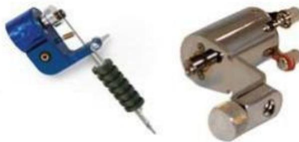
As máquinas tipo Rotary são cada vez mais populares e utilizadas pelos tatuadores. As máquinas são fabricadas com motores de alta rotação. Na em todo mundo, sobretudo na Europa, estas máquinas são cada vez mais aceitas por serem silenciosas, leves e potentes. A fabricação das máquinas Rotary iniciou-se na Suíça e hoje é amplamente utilizada na prática da Maquiagem Definitiva.
