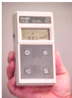
Detetor Geiger Muller digital, atua numa faixa de energia de 40 keV até 3 MeV com precisão de \pm 20\% , possui escalas automáticas de 1 \mu Sv/h até 9,99 mSv/h, com peso de 500 gramas
