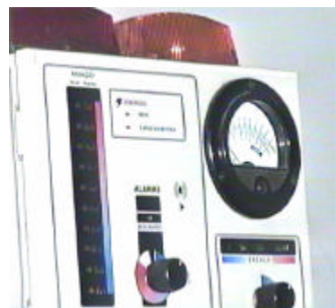
Medidor e Monitor de área sonoro e luminoso, opera com detetor Geiger Muller
