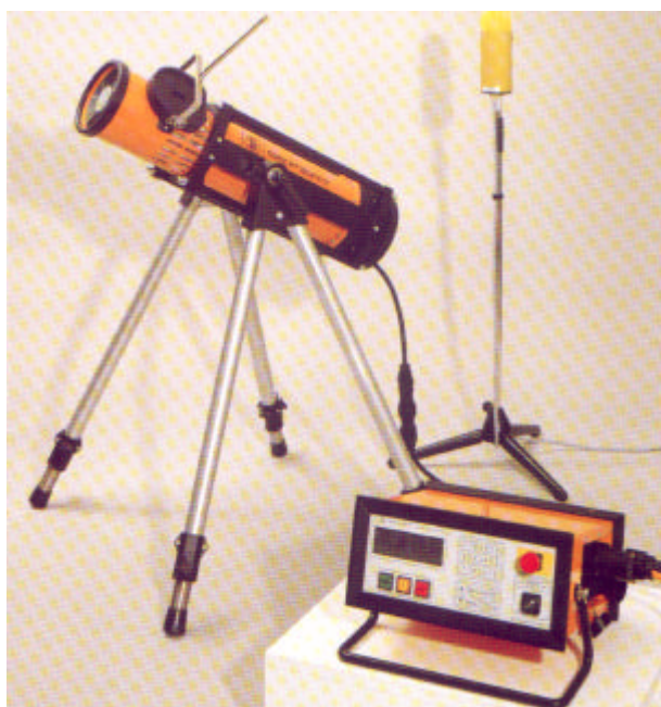
Equipamento gerador de radiação ionizante industrial , direcional, pesando 24 kg e a mesa de comando 13 kg , tamanho focal 1,5 mm , com tensão de 20 a 200 kV e corrente de 0,5 a 10 mA. (extraído do catálogo da Seifert/GE Eresco 200 MF)
