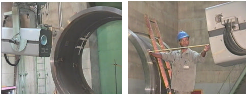
Fotos de um acelerador linear usado para radiografia industrial de peças com espessura de 20 a 300 mm de aço.
