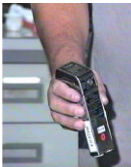
Monitor sonoro e dosímetro digital de leitura direta, opera com detetor Geiger Muller
