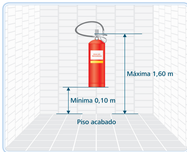
Figura 3.1: Posicionamento do extintor de incêndio em parede
