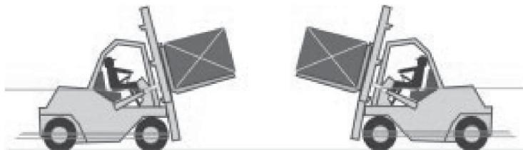
Não ultrapasse outros veículos quando em cruzamento, em locais que ofereçam perigo, ou se estiver com a visão obstruída. Pare e buzine em todas as esquinas, entradas, saídas ou diante da aproximação de pedestres.
