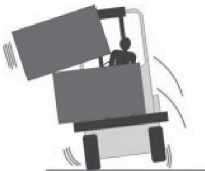
Diminua a velocidade nas curvas, nas rampas, nos cruzamentos, nas superfícies molhadas ou escorregadias. Não tente fazer curvas nas rampas ou terrenos inclinados.
