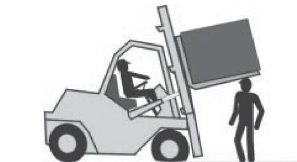
Não permita a permanência ou passagem de pessoas sob ou sobre os garfos ou qualquer outro acessório instalado na torre de elevação da empilhadeira.
