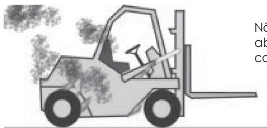
Não fume, não acenda fósforos e desligue o motor quando abastecer ou carregar a bateria. Limpe o excesso de combustível antes de ligar novamente o motor.
