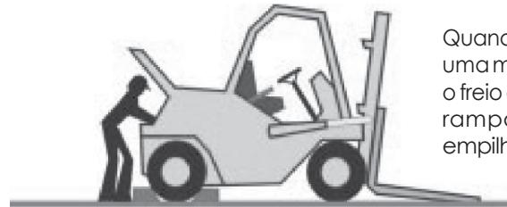
Quando deixar a empilhadeira, desligue o motor, engate uma marcha, abaixe completamente os garfos e puxe o freio de mão. Calce as rodas quando estacionar numa rampa e sempre que estiver fazendo reparo na empilhadeira.
