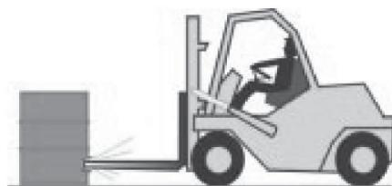
Não use os garfos para empurrar. Empurrar cargas com a empilhadeira pode danificar a carga ou a máquina.
