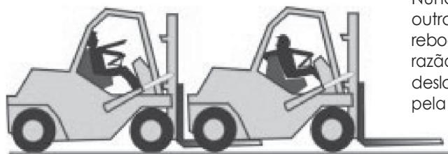
Nunca use sua empilhadeira para empurrar ou rebocar outra. Não permita também que ela seja empurrada ou rebocada por qualquer outra. Se a máquina, por qualquer razão, parar de funcionar repentinamente e precisar ser deslocada, avise imediatamente a pessoa encarregada pela sua manutenção.
