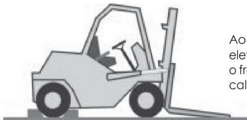
Ao estacionar, em área apropriada, incline a torre de elevação para frente; abaixe os garfos até o solo; aplique o freio de estacionamento; retire a chave do contato e calce as rodas quando em declives.
