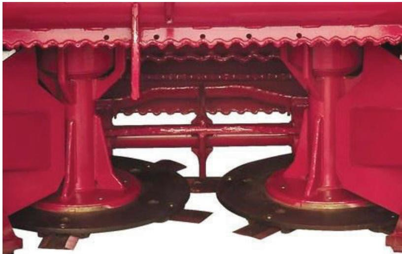
Utilizar as facas de cortes nos quatro lados até o ponto de arredondamento.
