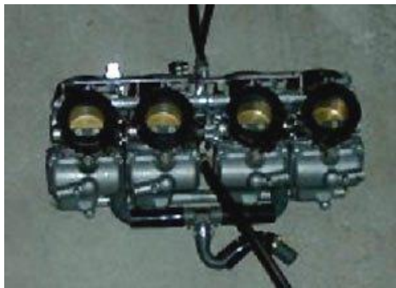
Grupo de quatro carburadores com sistema de acionamento do acelerador combinado, permite ajuste individual de cada borboleta
