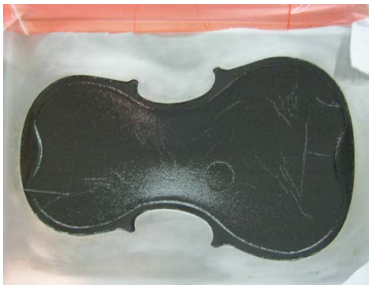
Figura 4: Exemplo de aplicação de material alternativo à madeira num tampo de violino.
