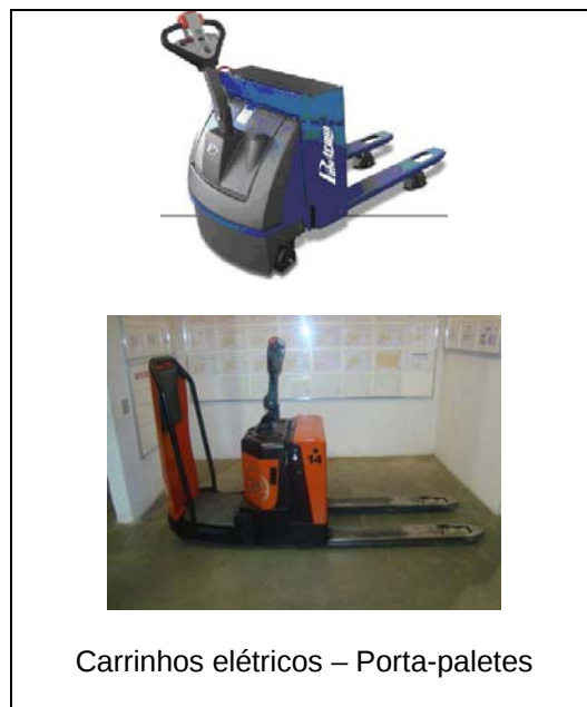
Figura 2 - Equipamentos de Manuseio - Sistemas Semi-Automatizados.
