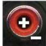
é encontrada na saída de tape decks, aparelhos de CD (do tipo não portátil) e os, já quase obsoletos, toca-discos de vinil. Por oferecer apenas dois contatos este plug não conduz sinais平衡ados e geralmente indica que o equipamento que o utiliza não é destinado ao uso profissional.
