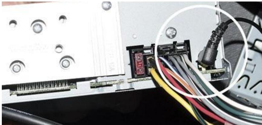
5) Conecte o cabo de antena que fica ao lado oposto da saída do chicote e do cabo de bluetooth.
