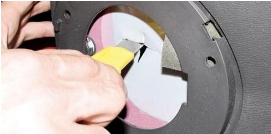
3) Busque o terminal de encaixe original do alto-falante, que está localizado na parte interna da porta do veículo.
