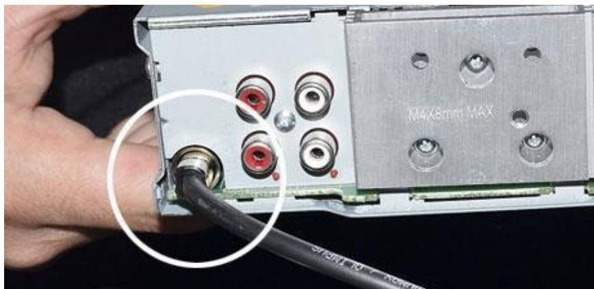
6) Verifique a posição da fiação para não atrapalhar o encaixe do aparelho no console central e coloque-o no lugar. Pressione até ouvir o clique da trava da cinta metálica.
