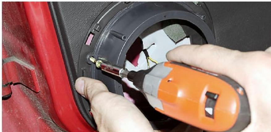
6) Conecte os terminais do sistema original do carro ao alto-falante. Fique atento às conexões positivas e negativas, indicadas no alto-falante pelos sinais + e -. Lembrando que, neste carro especificamente, o fio amarelo é positivo e o marrom/amarelo é o negativo.
