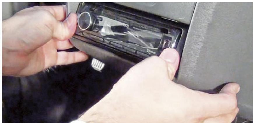
7) Ligue a ignição do carro para acionar o aparelho. Pressione o botão “knob” para desligar a função “Demo” do módulo. Selecione o “Yes” (Sim) e o aparelho estará pronto para uso.
