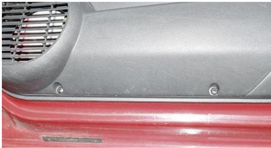
2) Após a remoção da bolsa, faça um corte em "X" no plástico que protege o acesso da parte interna da porta.
