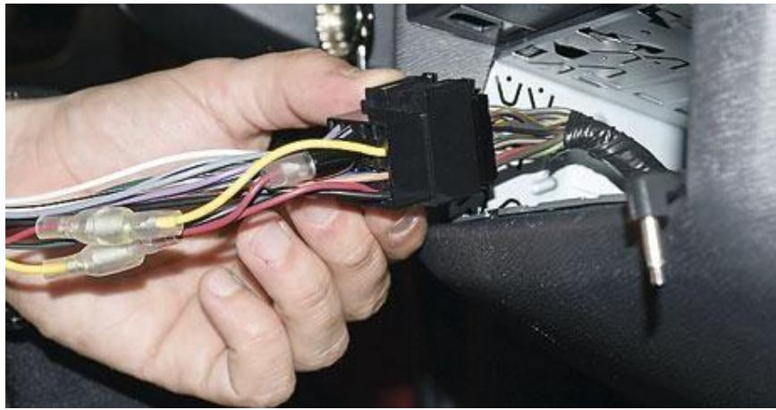
4) Ligue o microfone do bluetooth ao aparelho, na entrada que fica ao lado da saída do chicote elétrico.
