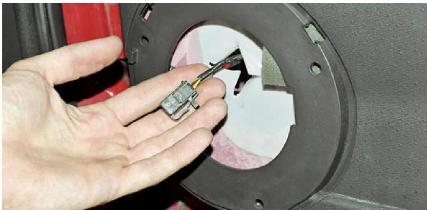
4) Com uma chave de fenda, retire o conector original para utilizar apenas os terminais.
