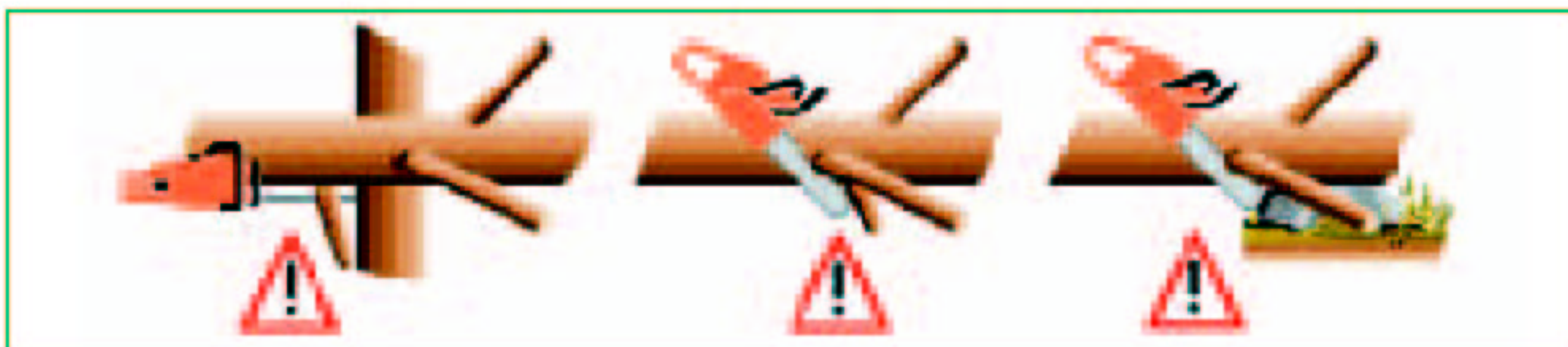
Figura 19 – Situações de perigo de ressalto da motosserra no caso do corte de ramos
