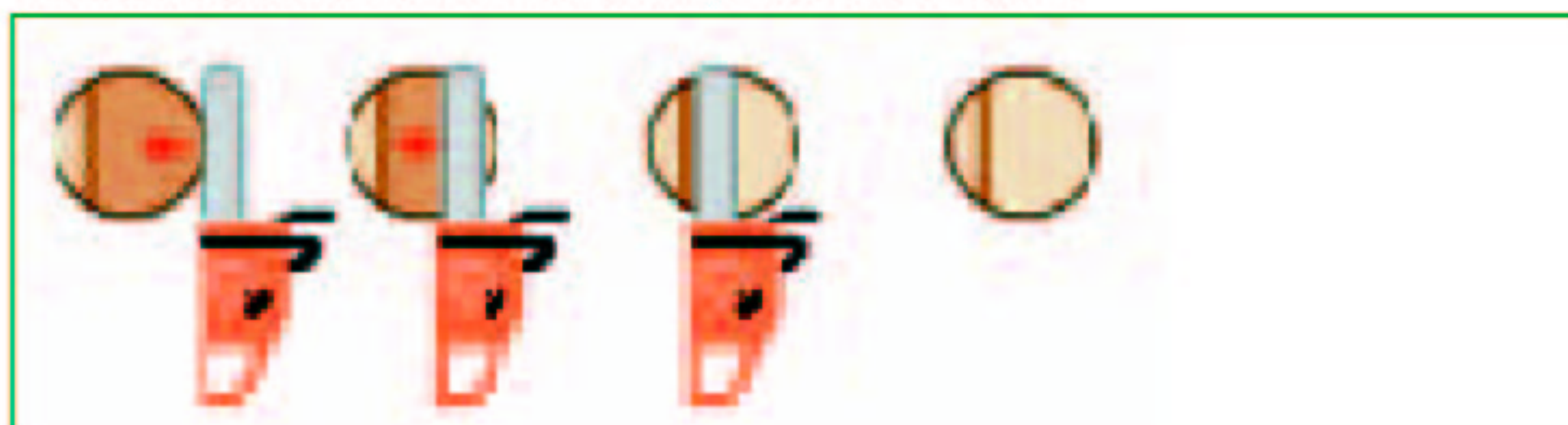
Figura 9 – Realização do corte de abate em árvores com diâmetro inferior ao comprimento da lâmina: nestes casos, o corte de abate pode ser realizado num só movimento
