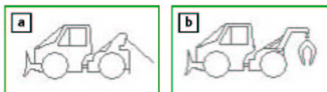
Figura 29 – Skidder : a) com guincho e cabos; b) com pinças
