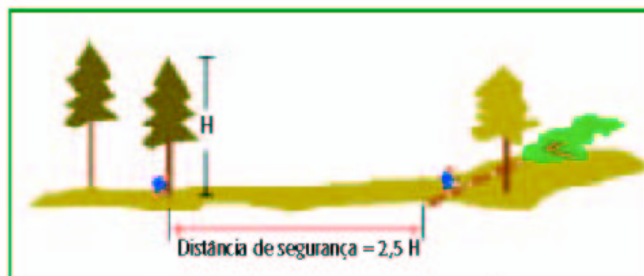
Figura 14 – Distância de segurança no abate de árvores
