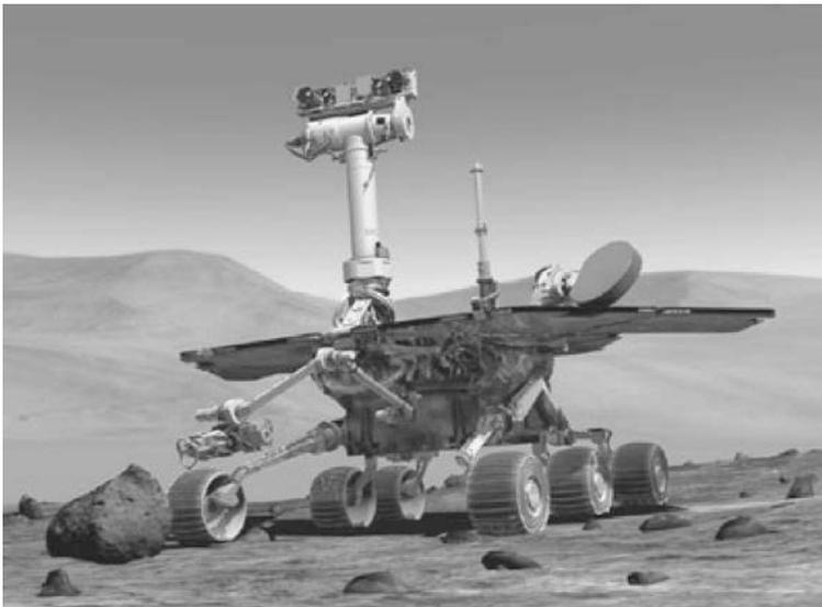
**Figura 1.7** – O *Mars Exploration Rover* é um laboratório móvel geológico utilizado para estudar a história da água em Marte. Os engenheiros mecânicos contribuíram para o projeto, propulsão, controle térmico e outros aspectos desses veículos robóticos.
