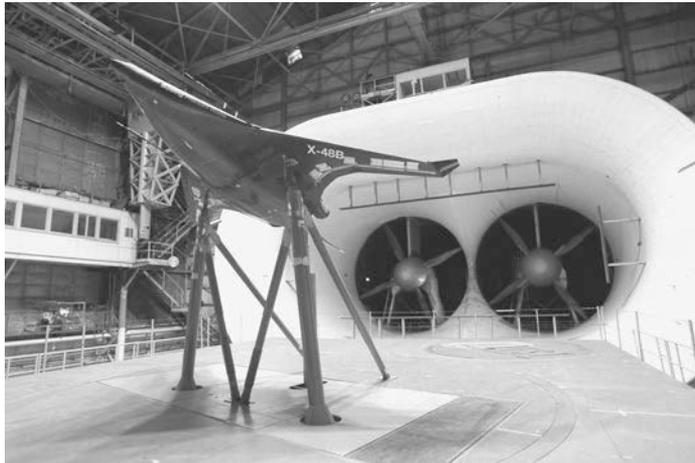
**Figura 1.11** – Esse protótipo do X-48B, uma aeronave de fuselagem integrada, está sendo testado em um túnel de vento subsônico no Centro de Pesquisas Langley da NASA, Virgínia. Cortesia da NASA.
