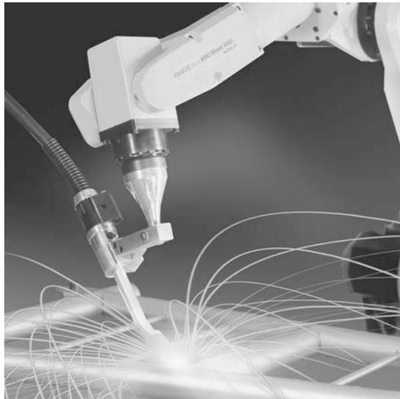
**Figura 1.1** – Os robôs são usados extensivamente em linhas automatizadas de montagem industrial que requerem precisão quando são desempenhadas tarefas repetitivas, como soldagem a arcos. Reimpresso com a permissão de FANUC Robotics North America Inc.
