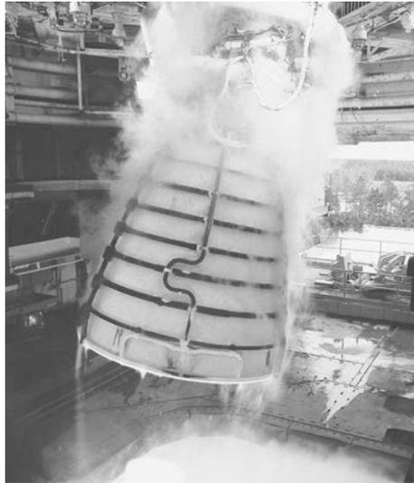
**Figura 1.3** – Destaque do motor principal de uma nave espacial durante teste de pivotamento para avaliar o desempenho de manobrabilidade em condições de voo. Cortesia da NASA.
