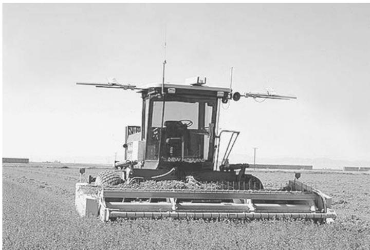
**Figura 1.10** – Os veículos-robôs em desenvolvimento podem aprender o formato e o tipo de terreno de uma plantação de grãos, e fazer a colheita dos grãos sem praticamente nenhuma supervisão humana. Reimpresso com a permissão do National Robotics Engineering Consortium.
