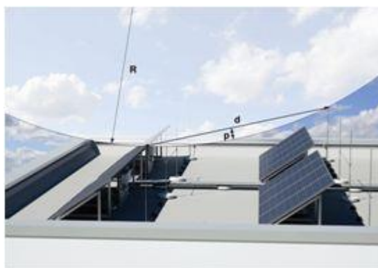
Figura 5 – painéis solares dentro da zona de proteção de um SPDA.
