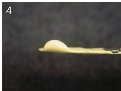
Cimento espaturado de forma homogênea
