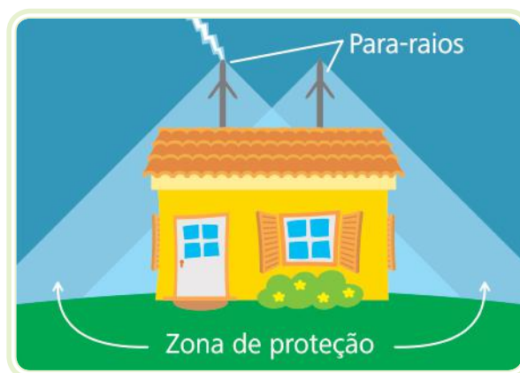
Figura 1.11: Aplicação de para-raios
