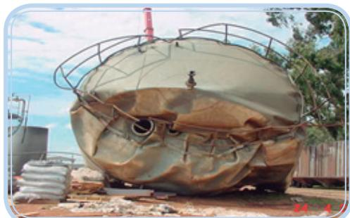
**Figura 20.3: Visão superior do tanque que explodiu**
