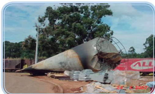
**Figura 20.4: Visão lateral do tanque que explodiu**
