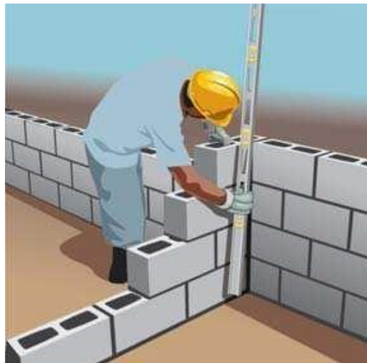
Figura 14 – Assentamento de bloco, ABCP, 2003.
