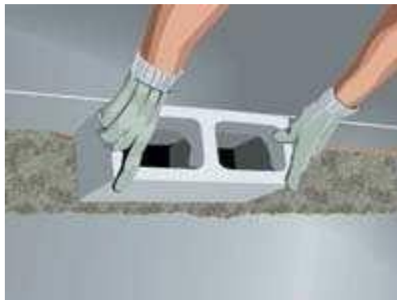
Figura 12 – Assentamento de bloco, ABCP, 2003.
