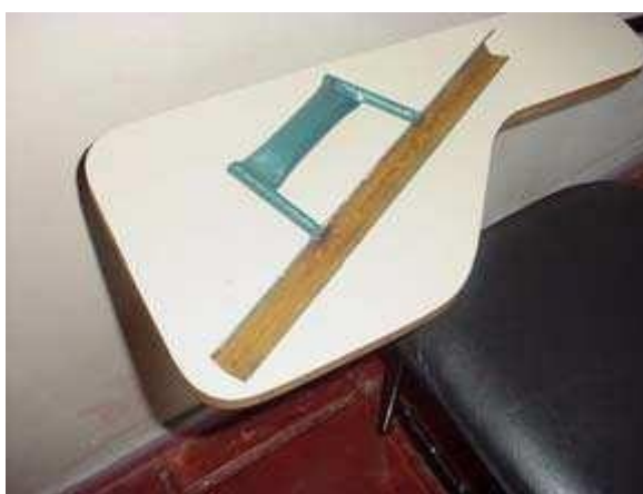
Figura 31 – Meia cana metálica, ABCP, 2003.
