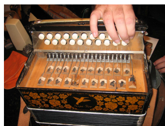
válvula de ar acionada por um botão
