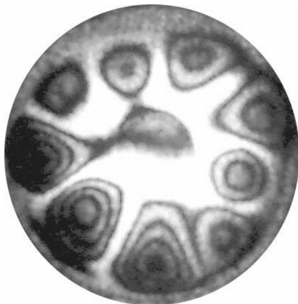
Figura 6.16: Membrana de um alto-falante excitada por uma tensão de 3.0 kHz e analisada pela técnica de holografia interferométrica em média temporal. O fundo brilhante indica a região em repouso, a 1ª franja escura indica amplitude de vibração de 0.12\mu\text{m} , a segunda 0.28\mu\text{m} e a 3ª 0.44\mu\text{m} . A tabela ao lado indica as amplitudes de vibração que correspondem aos máximos (brilhante) e aos mínimos (escuro) de luz.
