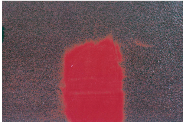
Figura 9.4: Experimento de Abélès mostrando a imagem do filme com a luz incidindo no ângulo de Brewster: o substrato sem filme (tarja central) tem o mesmo brilho que o restante da placa com filme
