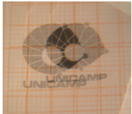
Figura 7.13: Refração em cristal de calcita, mostrando as imagens devidas aos raios ordinário e extraordinário
