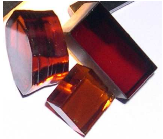
Figura 6.12: Cristais de \text{Bi}_{12}\text{TiO}_{20} e \text{Bi}_{12}\text{SiO}_{20} crescidos por J.F. Carvalho, no IFUFG, Goiânia-GO, em diversos estágios de preparação.
