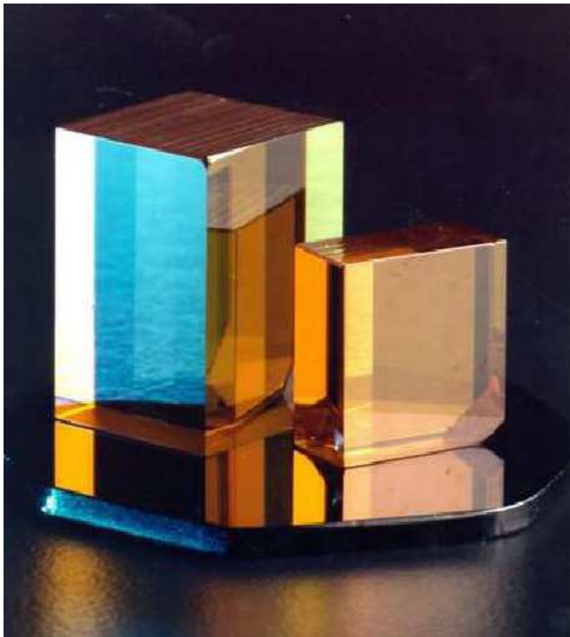
Figura 6.10: Cristais fotorrefrativos de \text{Bi}_{12}\text{GeO}_{20} crescidos por J.C. Launay na Universidade de Bordeaux, França: dopado com Fe (à esquerda), dopado com Cr (embaixo) e não dopado (à direita)
