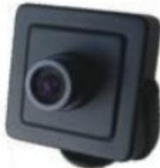
**Micro-câmeras Pin Hole:** São micro-câmeras com uma lente de tamanho extremamente reduzido, sem ter qualquer tipo de prejuízo a captação da imagem. São geralmente utilizadas em locais ocultos, embutidas ou em aplicações onde o tamanho deva ser o menor possível. É possível captar imagens mesmo com orifícios de cerca de 1,5mm.
