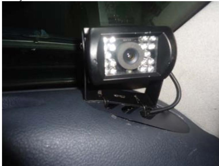
A câmera pode ser fixada na saída de ar da lateral direita do veículo, ou parafusada na mesma posição no painel, ela deve ser posicionada de forma que tenha a seguinte visada.
