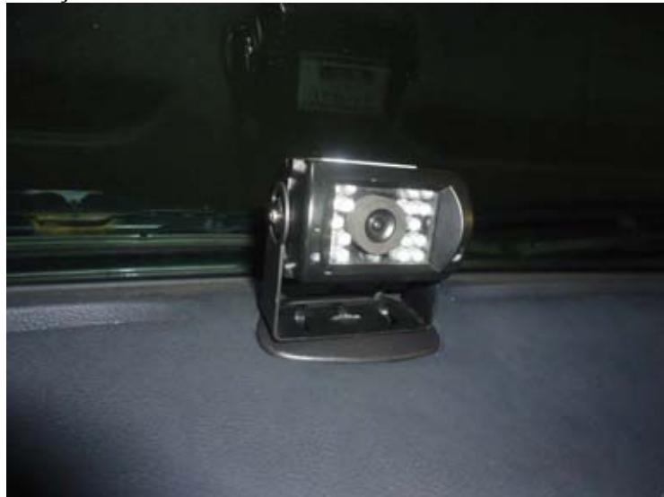
A câmera pode ser fixada na saída de ar central do veículo, ou parafusada no centro do painel, de forma que tenha a seguinte visada.
