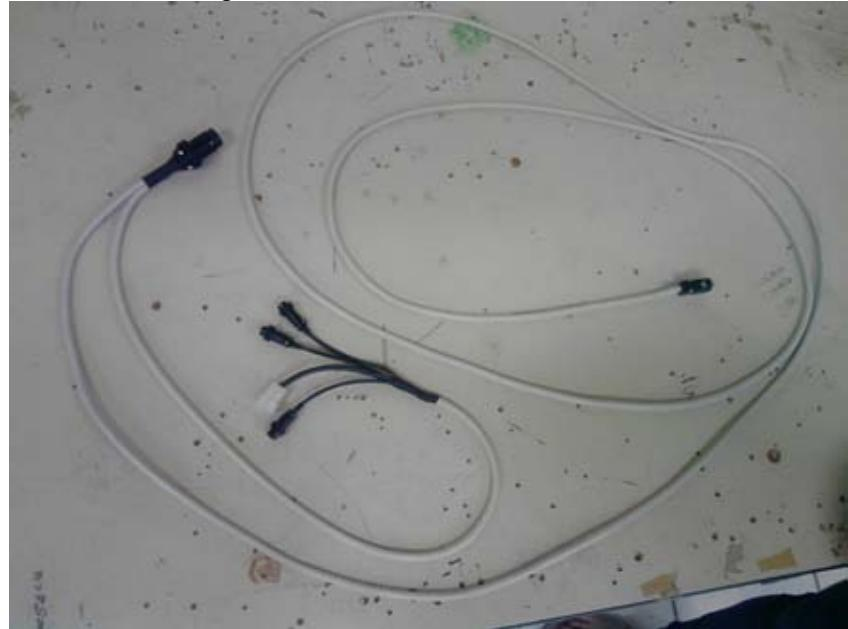
3- Chicote da bateria para a caixa de ligação: A alimentação do sistema deverá ser através de um cabo pp 2x2,5 com uma das vias da cor azul e a outra da cor branca ou preta, e o mesmo deve ter um fusível na sua ligação com a bateria. Para a padronização do sistema o cabo deve ser ligado com a via azul ligada no polo negativo da bateria e a branca ou preta no porta fusível que ficará ligado ao polo positivo da bateria.
