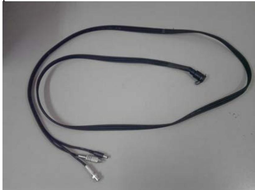
2- Chicote principal: Os conectores dos leitores biométrico e de código de barras, o cabo para os leitores deve ir diretamente do conector PA/PM37 até o conector DB15, sendo que o 16 fio deve ser soldado a carcaça metálica do conector DB 15. Os chicotes das câmeras e da bateria se interligarão nele.
