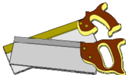
O **serrote de costinha** ou **serrote de faca** é muito usado para corte de rabo de andorinha. Sua lâmina é estreita e fina (0,5 a 0,6 mm), com dentes menores e espaçamento de 14 a 18 dentes por polegada. O comprimento adequado está entre 200 e 250 mm (10 a 12 polegadas). O travamento para este tipo de serrote deve ser mínimo, ou até inexistente. Pode ser encontrado com cabo do tipo “pistola”, preferido por alguns marceneiros para este tipo de serrote.
