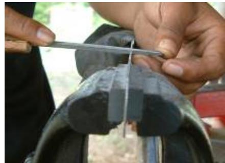
No final da afiação, para retirar as rebarbas do travamento e da afiação pode-se passar a lima chata nas superfícies curvas dos dentes, de um lado e do outro, no sentido longitudinal do serrote, sempre do cabo para o final da lâmina.
