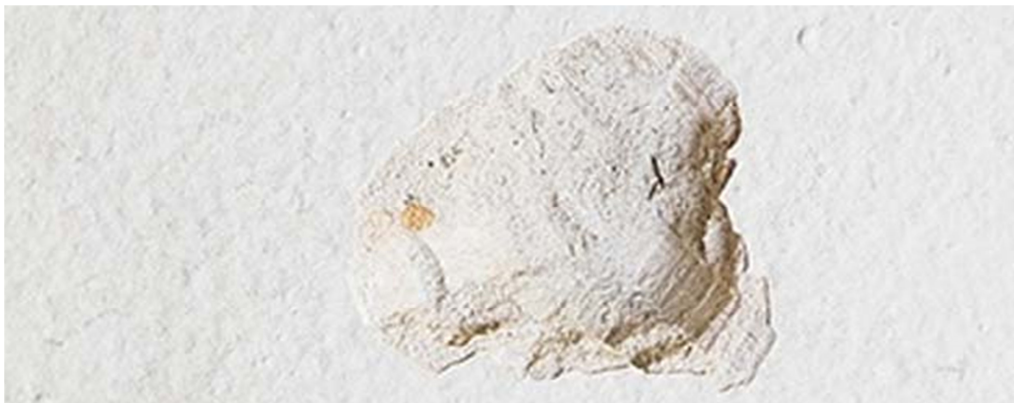
Figura 2.3.1 – Massa Corrida para preparação da Parede
