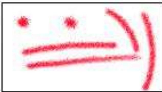
Neste exemplo o problema é de sujeira no aerógrafo. Repare que o traço tem em torno de si uma névoa, produto de um desvio de tinta causado por alguma sujeira. Para se obter bons resultados com o aerógrafo é imprescindível que este esteja bem limpo e que as tintas sejam coadas antes do trabalho, para evitar a sujeira e o entupimento da pistola.
