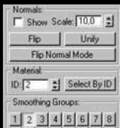
Imaginando que vc já saiba perfeitamente o conteúdo do tutorial Mult/Sub-Object não vou me perder em detalhes, portanto transforme em Mesh o cabo e ligue o Sub-Object Face, selecione todas as faces do cabo e aplique ID = 1 a elas, em seguida selecione apenas as faces do centro, onde vai segurar, como mostra a primeira imagem ao lado, e atribua ID = a 2 a estas.
